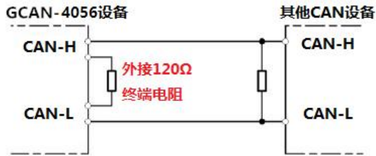
图 2 GCAN-4056 与其他 CAN 节点设备连接
