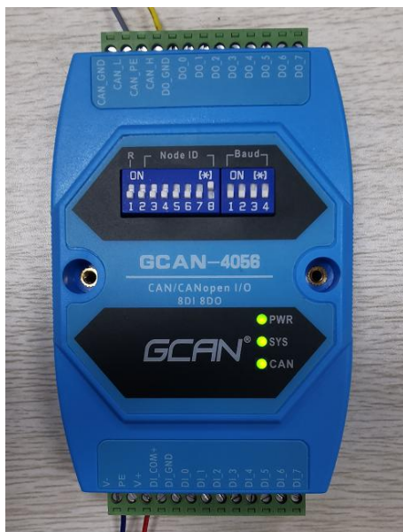
图3.1 GCAN-4056 PWR、SYS和CAN灯状态
