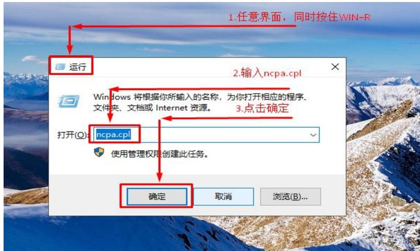
设置电脑 IP：选择对应网口=>右键选择属性=>IPv4=>属性=>使用下面的 IP 地址=>输入同网段 IP=>输入子网掩码=>确定=>逐级关闭界面即可
