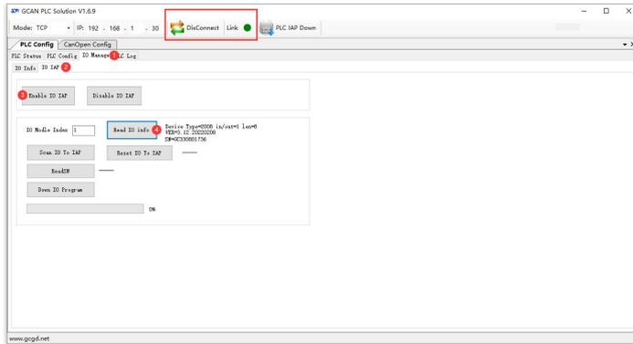
点击 Scan IO To IAP，后面会出现计时，这个时候上下滑动一下 IO 模块，然后会发现计时变成 Find io。点击 ReadSN，后面会显示出搭载的 IO 模块的 SN 号，点击 Down IO Program，然后选择对应的 IO 模块的固件文件，等待读条结束下载成功，IO 固件就下载完毕了，断电重启即可。
