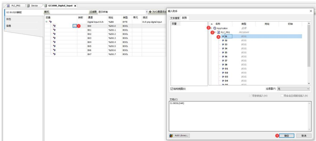
以此类推，我将所有的代表输入的变量都对应到了 1008 的 8 个端口上，这就是 IO 映射。而输出模块 2008 的映射和输入没有差别，只需要注意 2008 映射的变量是否是您需要的变量。
