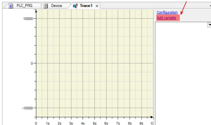
3) 点击“变量”栏右边的浏览图标，可以弹出输入助手，在随即打开的窗口中选择要跟踪的变量。
