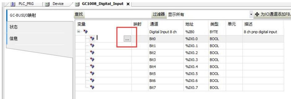
例如，我想让 Bit0（通道 0）对应到我写的 I1 这个变量上，点击...，点开 Application 的折叠栏，点开 PLC\_PRG 的折叠栏，选中 I1，点击右下角的确定。
