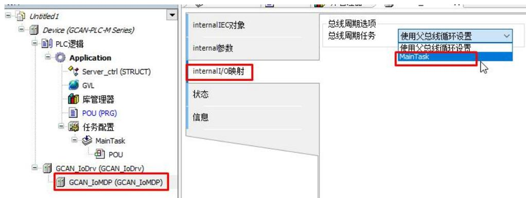
右键 GCAN\_IoMDP=>添加设备=>在界面选择对应的扩展 IO 型号=>双击设备树对应的扩展 IO 型号=>GCBUSI/O 映射=>Maintask=>使能 1
