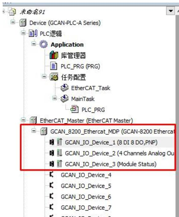
7.5 数据映射：选择 EtherCAT 从站=>EtherCAT I/O 映射=>选择要映射变量=>确定
