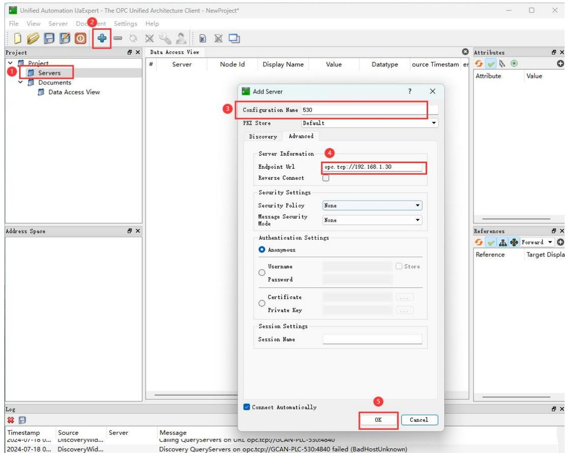
15).连接成功后，在 Server 下面后出现两个插头连接的标志后面跟着在“Configuration Name”中输入的名字
