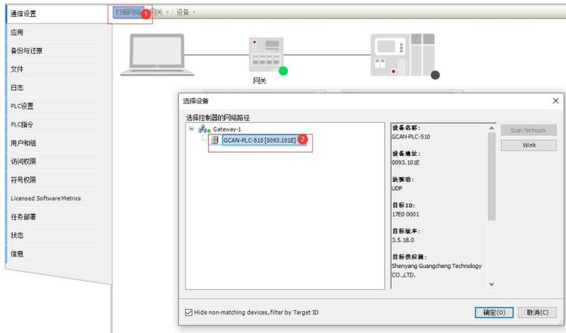
4) 如下图所示，即已完成网络连接，然后设备就通过网口连接到 CodeSys 软件上了。
