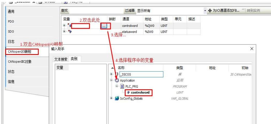
图 4 CANopen I/O 映射状态图
