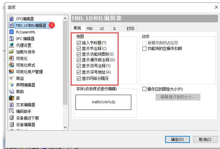
红框 1 内是给梯形图的触点和线圈标注，只需要在变量后输入/+备注就可以。
