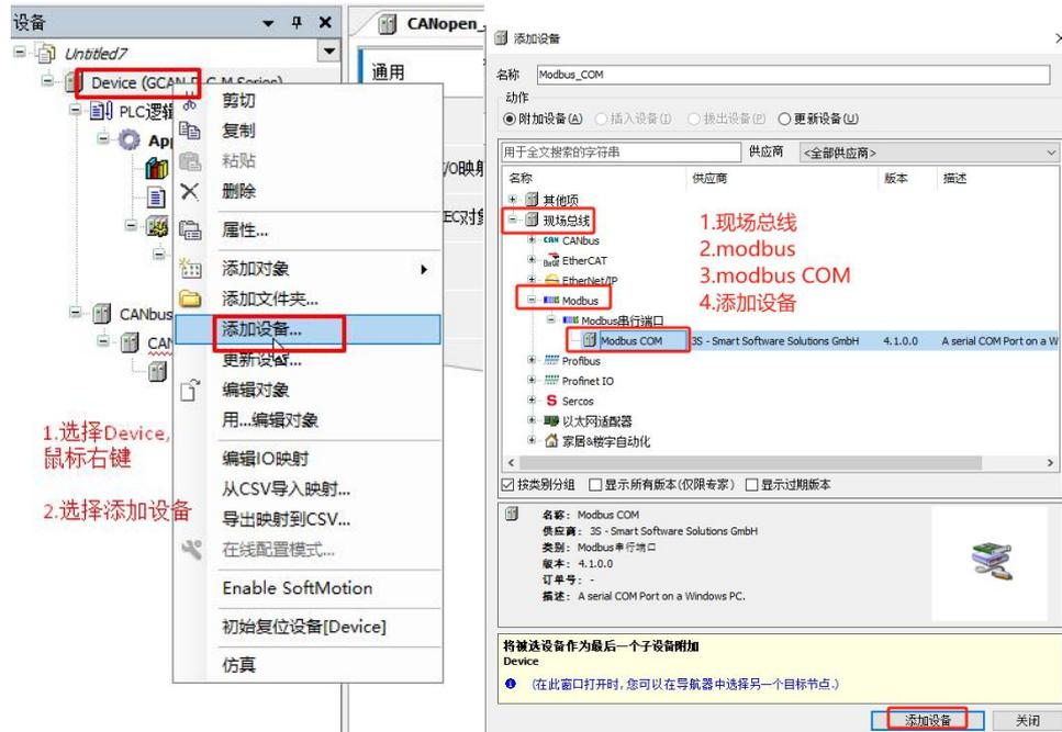
2) 右键 Modbus\_COM =>选择添加设备=>点击现场总线=>点击 Modbus=>点击 Modbus 串行主站 =>选择 Modbus Master,COM Port=>点击添加设备。
