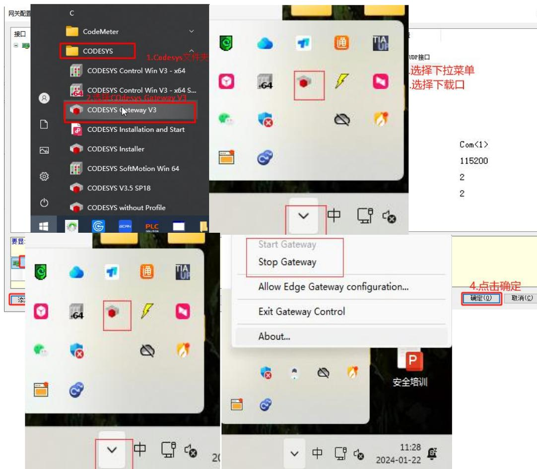
4) 开始菜单 Codesys Gateway=>电脑桌面右下角会出现 codesys 图标,=>右键小图标=>Stop =>Star Gateway。
