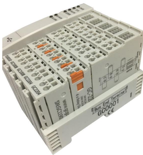
图 2.4 GC-0001 终端电阻模块安装方法
