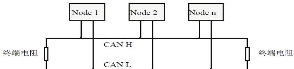
图 3.1 CAN-bus 网络的拓扑结构
