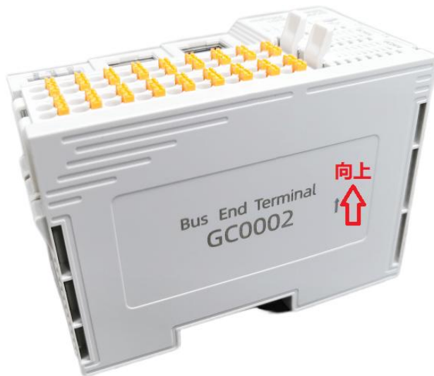
图 2.4 GC-0002 终端电阻模块安装方法
