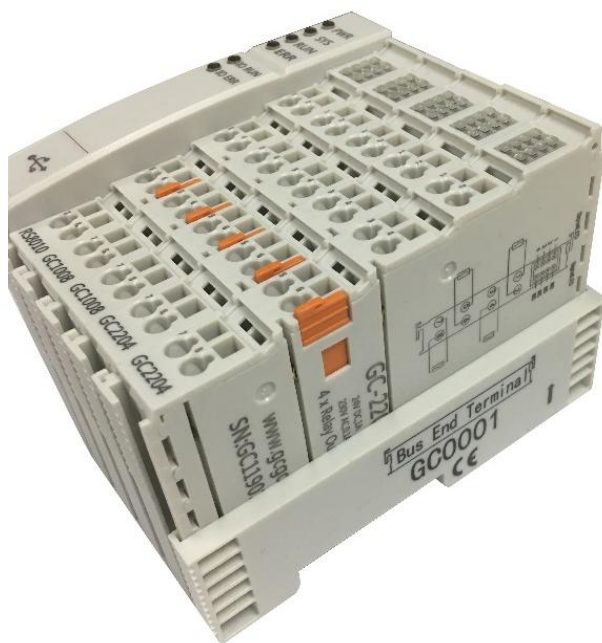
图 2.5 GC-0001 终端电阻模块安装方法
