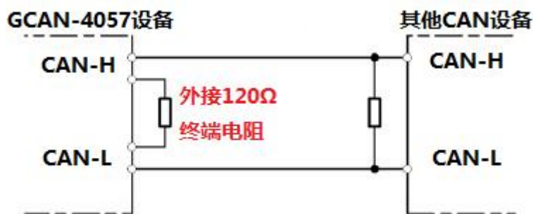
图 2 GCAN-4057 与其他 CAN 节点设备连接
