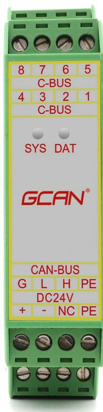
图 2.3 GCAN-206 模块接线端子排
