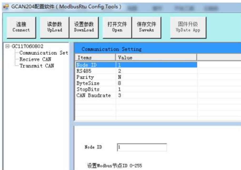
图 4.5 广成科技 GCAN-204 参数设置界面
