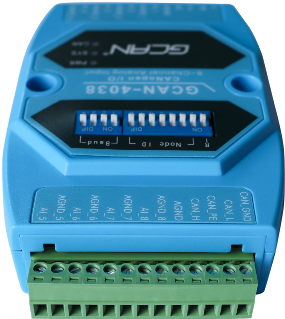
图 2.3 CAN-bus 接口、4 路模拟量输入接口位置
