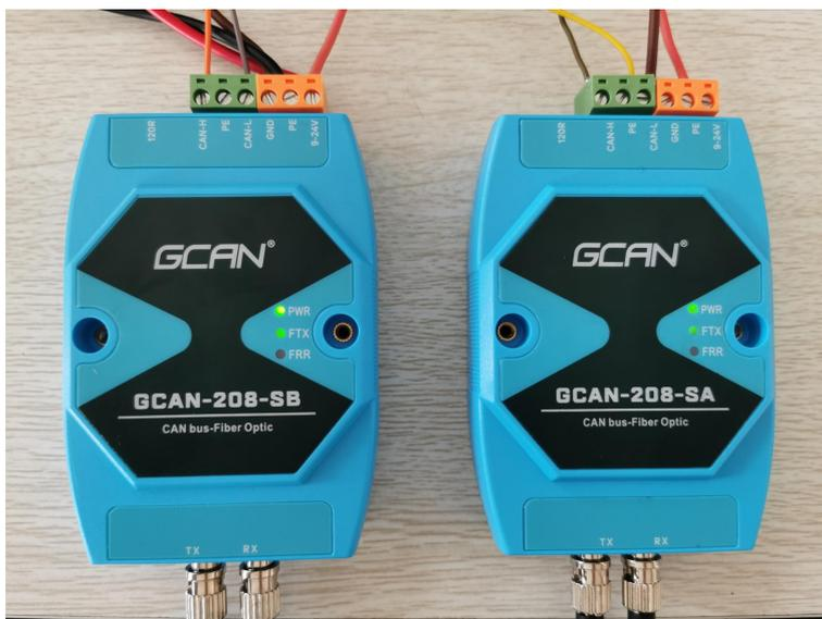
图 3.4 GCAN-208-S 系列模块 FTX 灯状态
