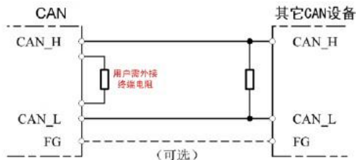
图3.5 GCAN-205模块与其他CAN节点设备连接
