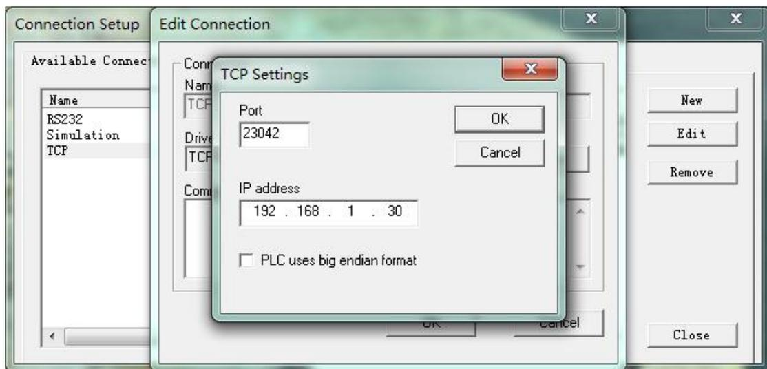
图 4.9 IP 地址及端口号设置
