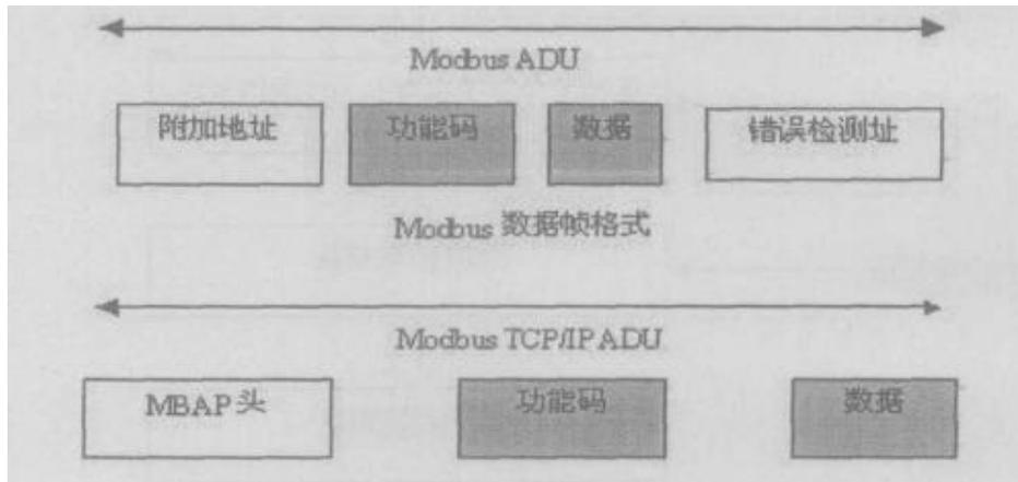
图 B.1 Modbus 与 Modbus TCP/IP 帧格式
