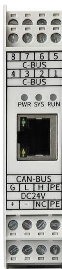
图 2.3 GCAN-GT-412 模块接线端子排
