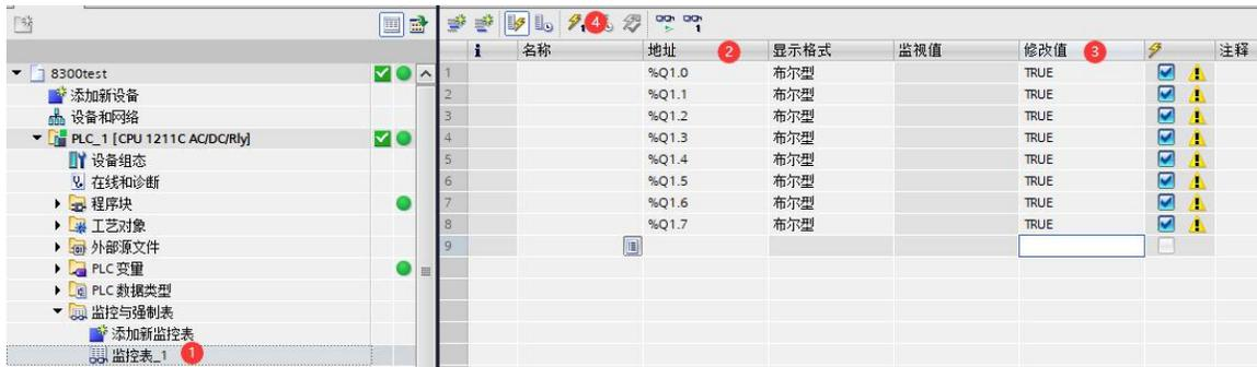
添加“新监控表”，点击“监控表\_2”。将输入模块地址，写入“地址”栏。点击“全部监视”。模块实物图，若此时输入模块 GC-1008 第 3 路有输入，“监控表\_2”如图所示。至此，就可以对 S7-1200 进行编程了。
