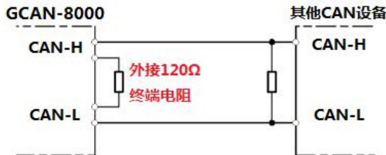
图 3.2 GCAN-IO-8000 与其他 CAN 节点设备连接
