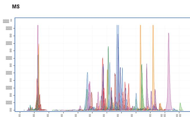
UV 图示出使用 ZORBAX RRHD 300-HILIC 2.1 × 100 mm 色谱柱分离的促红细胞生成素 (EPO) 肽谱, MS 图示出匹配的 EPO 的提取化合物色谱图。从 HILIC-MS 数据中鉴定出 7 种肽, 而这些肽通过 RP-MS 无法鉴定。HILIC 与 RP 正交, 为蛋白质酶解物的亲水性糖肽提供更高的分离度
