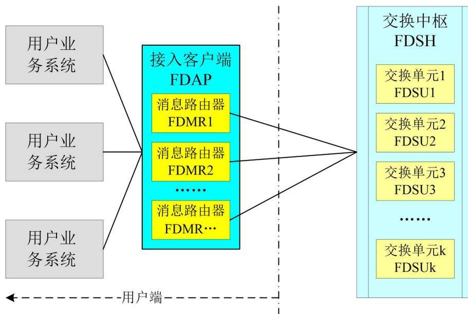
图9 接入客户端构成及连接示意
