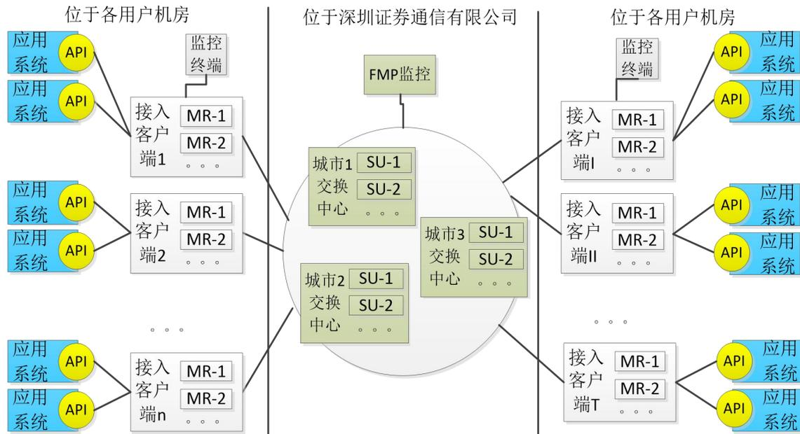
图 2 FDEP 消息传输系统整体架构
