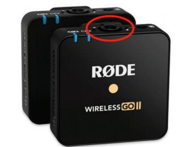
3.2 如果有现场扩声请将头戴麦克风插入发射机并调整好位置。并如图所示长按打开接收机。
